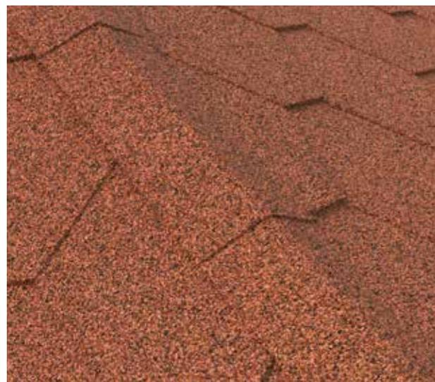
Битумно-полимерный СБС-модифицированный материал на основе из стеклохолста с крупнозернистой посыпкой на верхней стороне и слоем клеевого битума на нижней. Клеевой слой защищен антиадгезионной полиэтиленовой пленкой, которая удаляется непосредственно перед монтажом.
