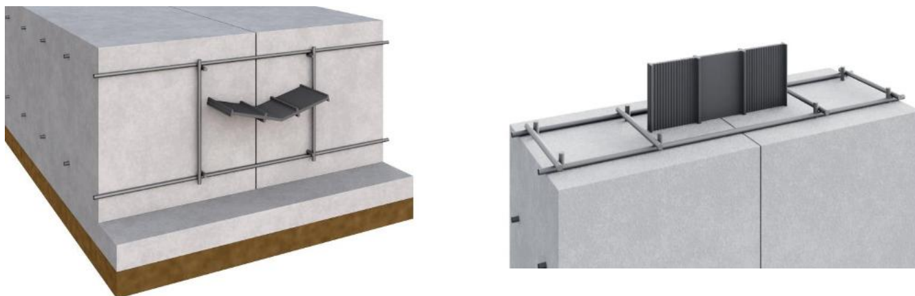
Рисунок 35 – Гидрошпонки ИКОПАЛ ХВ в холодном шве фундаментная плита-фундаментная плита и стена-стена
