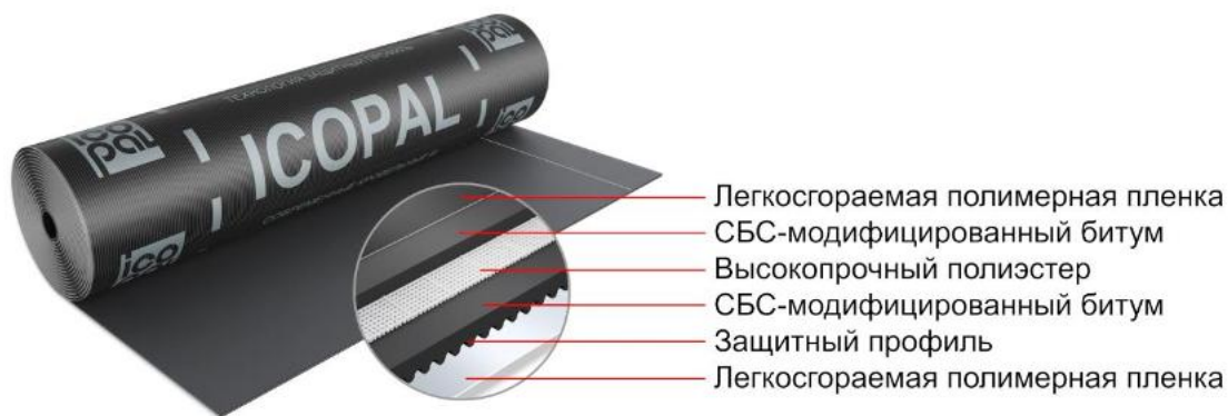
Рисунок 17 – Структура ИКОПАЛ Ультра Н ЭПП / ИКОПАЛ Н ЭПП
