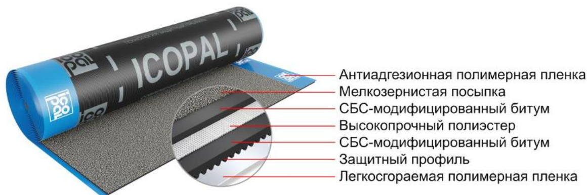
Рисунок 14 – Структура УЛЬТРАНАП
