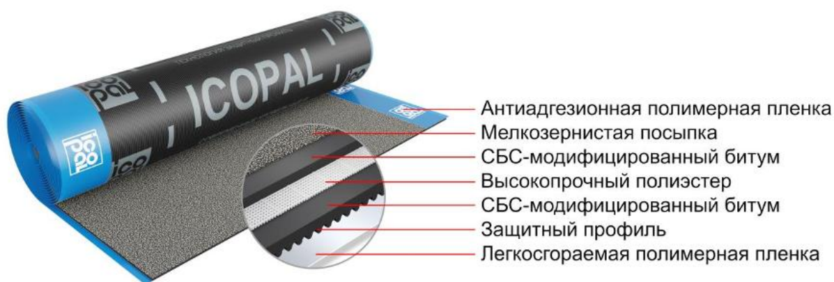
Рисунок 28 – Структура материала с технологией «надежный шов»
