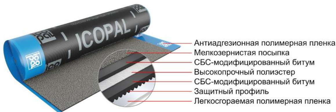
Рисунок 15 – Структура УЛЬТРАДРАЙВ
