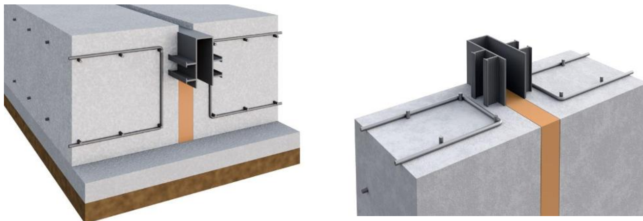
Рисунок 32 – Гидрошпонка ИКОПАЛ ДП в деформационном шве фундаментная плита-фундаментная плита или стена-стена
